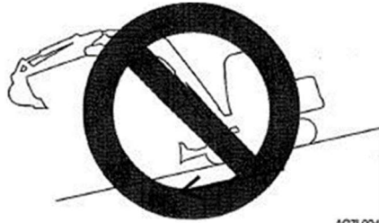
Крутий схил під час підйому навісного обладнання
